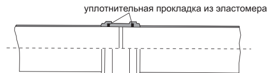
Рисунок 20 – Простое соединение эластичного типа, с уплотнительной прокладкой (эластомер)
