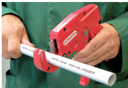
CUT / TAGLIO / ROHRABLÄNGEN / COUPER
