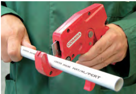
CUT / TAGLIO / ROHRABLÄNGEN / COUPER
