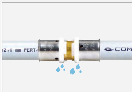
FITTING NOT PRESSED AND TESTED BETWEEN 1 AND 4,5 BAR - IT LEAKS / RACCORDO NON PRESSATO PROVATO DA 1 FINO A 4,5 BAR - PERDE / ZWISCHEN 1 UND 4,5 BAR GEPRÜFTER NICHT VERPRESSTER FITTING - UNDICHT / RACCORDS NON SERTI, TEST EN PRESSION À 1-4,5BAR - IL FUIT
