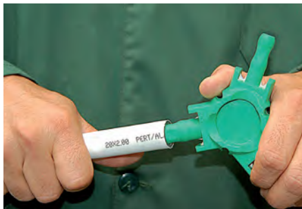
CALIBRATE - DEBURR OF THE PIPE / CALIBRAZIONE DEL TUBO / KALIBRIEREN/ ENTGRATEN / CALIBRER ÉBAVURER
