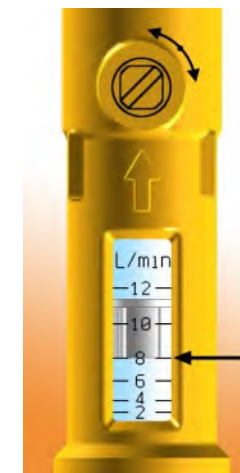
Мал. 14. Корпус лінійного витратоміра PRAWTECH типу А: 2–12 л/хв
